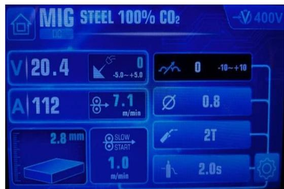
Beeinflusst durch Schweißgrößen, z.B. Materialart, Schutzgasanschluss, Schweißstrom, Drahtgröße.
